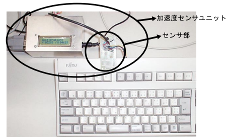
図 2: キーボードに取り付けた加速度センサ
