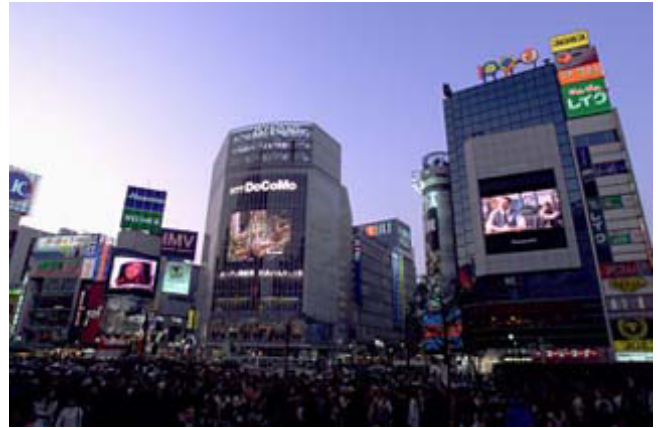
Figure 3: 屋外のビーコン例 (イメージ): 看板の照明や信号機、巨大なディスプレイ、ビルの警告灯などがビーコンとして機能することができる。
