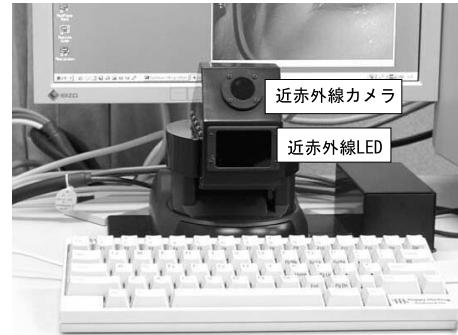
図 1: 視線測定システム FreeGaze
