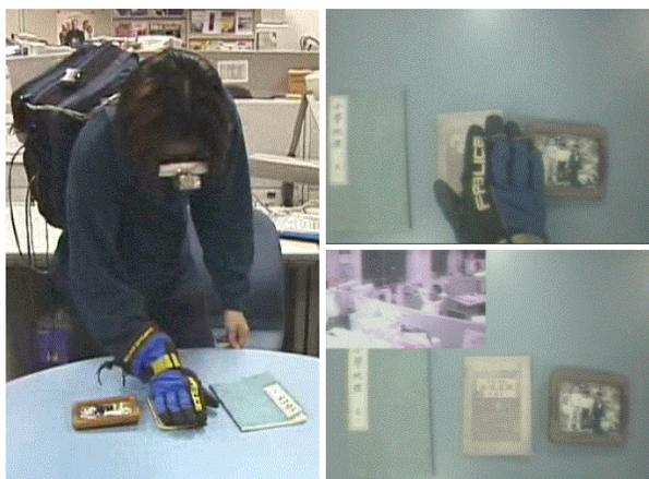
図2: 利用者がシステムを装置し、RFIDタグリーダを介して対象に触れることで、対象に関連付けられた記憶を参照している(左)、対象に触れる(右上)、関連付けられた映像が再生される(右下)
