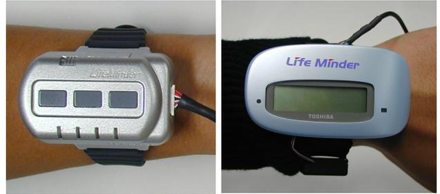
図 1 腕時計型生体センサ
