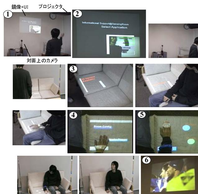
Fig. 4: 手振り選択と投影 UI 選択によるサービス選択
