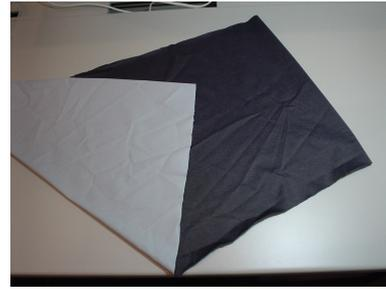
図 4: 試作した導電性素材 (白色部がフィルムでラミネートした部分)
