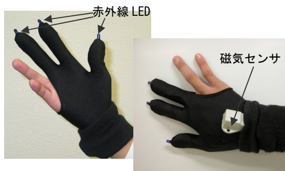
図3 ジェスチャ入力のための手袋デバイス
