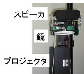
図 1: 鏡つきプロジェクタおよび狭指向性スピーカ
