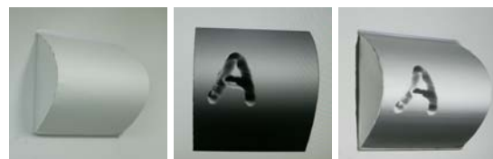
図 3 白色実物体（左）、投影画像（CG 画像）（中）、投影結果（実写）（右）
