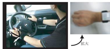
図3 運転者に取り付けた加速度センサ
