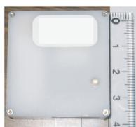
図2 小型無線加速度センサ
