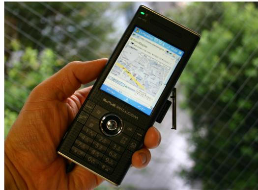
図 1 PlaceEngine を使用した位置推定の例：通常の Web ブラウザ上で現在位置の取得および現在位置を基点とした情報検索が可能になる
