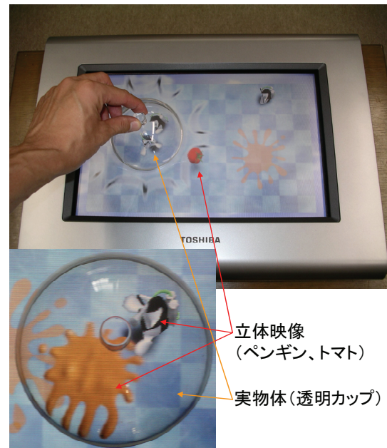
図2. 筐体の全景(上)、透明カップに付着したトマトの映像(下)
