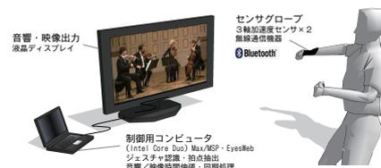
図1 システム構成：音響映像制御システム
