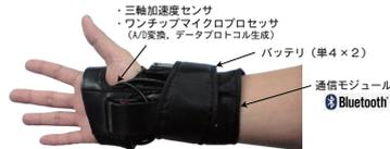
図 3 AccGlove : センサグローブの構成
