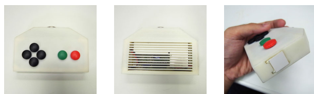
図 2 左：コントローラ前面，中央：コントローラ背面，右：側面に配したペルチェ素子
