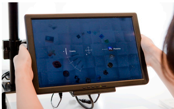
図 4 タッチパネルに指が触れると、スパイラル状のアプリケーション・ランチャーが表示される。上下に指を動かすことにより、左側ではカテゴリ、右側ではアプリケーションを選択する。タッチパネルを押込むことにより決定操作になる。
