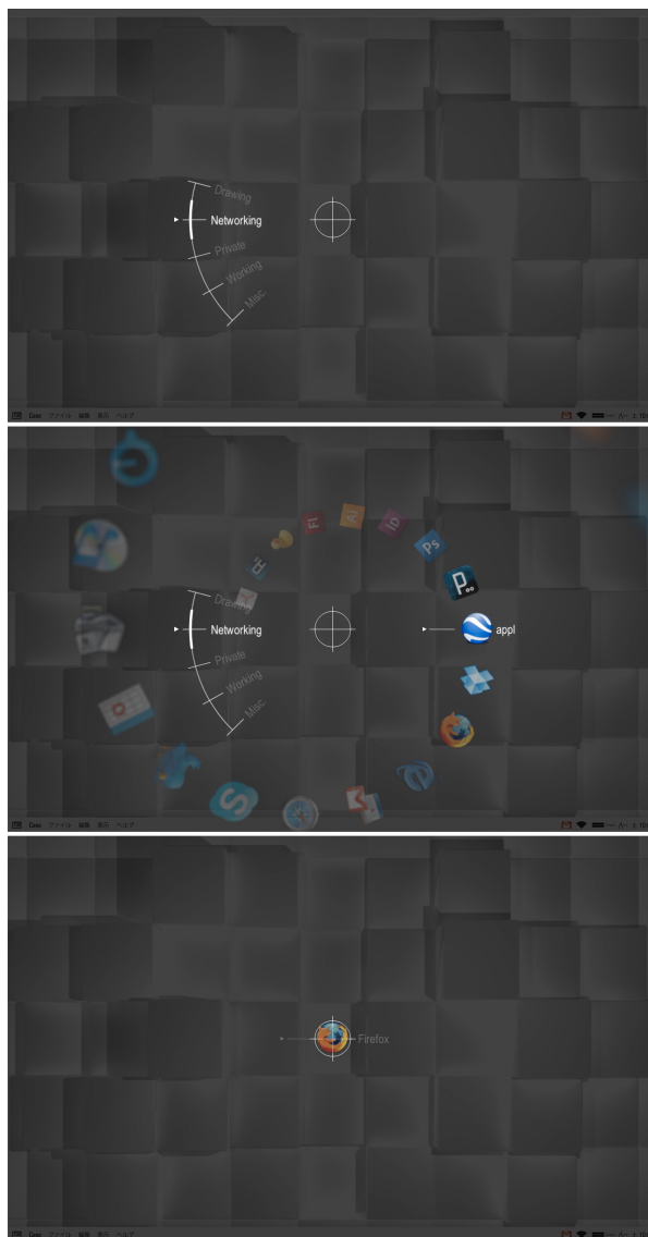
図 5 上：左側のタッチパネルに触れた時に表示される初期画面。アプリケーションのカテゴリを選択、決定する。中：カテゴリを選択するとスパイラル状にアプリケーションのリストが表示され、右側のタッチパネルで選択、決定する。下：決定するとアプリケーションが起動され、ランチャーはフェードアウトする。
