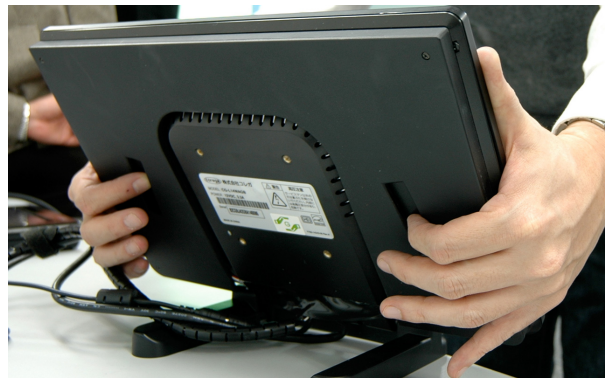
図1 ディスプレイ背面の様子。左右に2組のタッチパネルが配置されている。タッチパネルの周囲には操作可能な範囲を示すガイドがあり、触覚で操作範囲を把握することができる。また、掌で自然に隠れる位置に近接センサを配置している。
