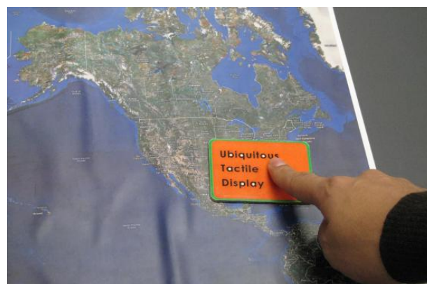
図4 地図裏面に貼付された金属パターンに対応して振動のオンオフが切り替わる
