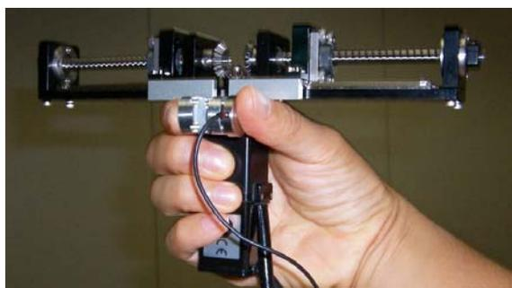
図2 携帯型力覚デバイスの 1 号機
