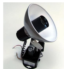
図2 Sociable Spotlight のアクチュエータ部一組 (天井などに三組設置する)
