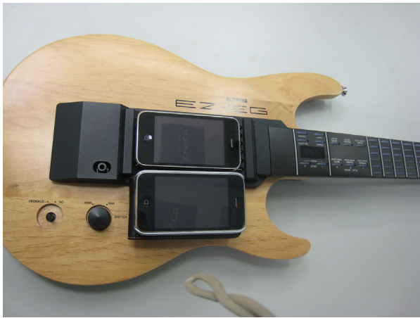
図 3 電子擦弦楽器のプロトタイプ。ピッチ入力部には EZ-Guitar, マルチタッチディスプレイ部には iPhone を用いている。
