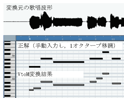
図3 音高変化によって区切られ、余計な音が入力された例(赤とんぼの「おわれてみた」)
