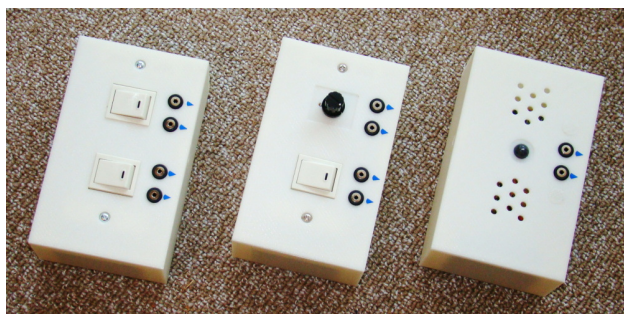
図 4 試作した入力モジュール。左からスイッチモジュール・ボリュームモジュール・焦電センサモジュール。
