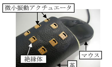
(a) マウスに装着された触覚ディスプレイ
