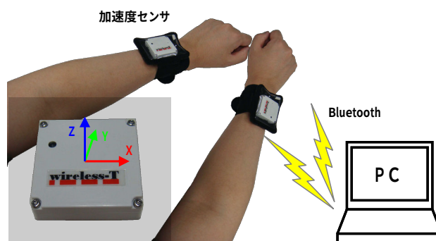
図2 本システムの機器構成
