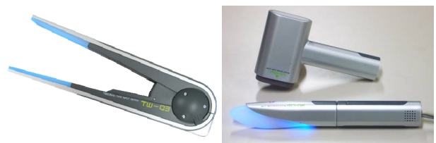
図 1 道具型デバイス (左：ピンセット，右：ナイフ，ハンマ型デバイス)
