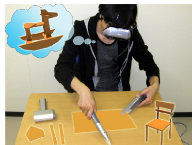
図 2 道具型デバイスを用いた木材加工システム (イメージ図)
