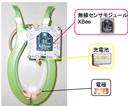
図 8 クリックタイプのデバイス
