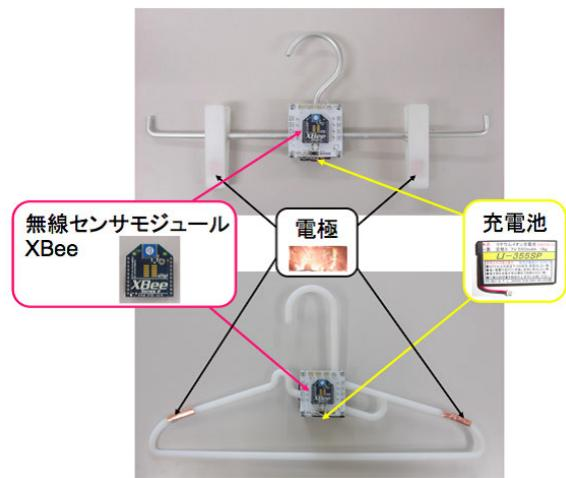
図 2 製作したハンガー(上:ボトムス用、下:トップス用)
