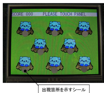
図 7 モグラ叩きゲームの画面。タッチパネル付のカラー液晶に表示する。液晶には、モグラの穴の位置を示すシールを貼っている。 Fig. 7 Screen of the whack-a-mole game. The position of the hole is shown by round markers.
