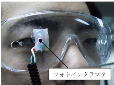
図 1 眼鏡型瞬目検出装置の瞬目検出部分。瞬目を検出するセンサとして赤外線反射型のフォトインタラプタを右眼前に固定している。
