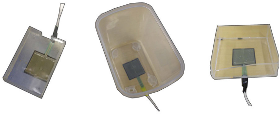
図 3 設置した圧力センサ, 左から: 豆乳, 小麦粉, コーヒー豆 Fig. 3 Placed pressure sensors, from left : soy milk, flour, coffee beans
