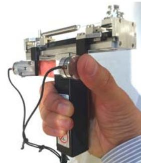
図 2 開発した携帯型力覚提示デバイス 3 号機
