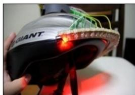
図3 方向表示 LED 発光装置と表示法
