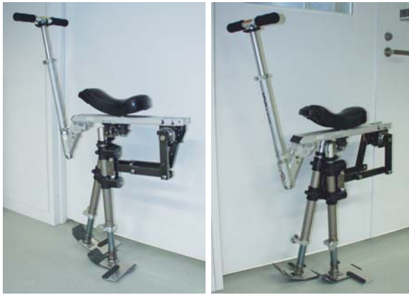
図 2 受動歩行ベースの人力乗用二足歩行機の試作機 Fig. 2 The prototype of the human powered passive bipedal walker with the saddle
