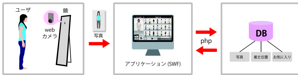
図 2 suGATALOG のシステム構成 Fig. 2 The system architecture of suGATALOG
