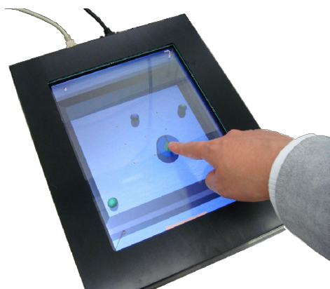
図1 パネル駆動型力覚提示タッチパネル
