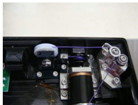
図4 ワイヤによる張力伝達機構
