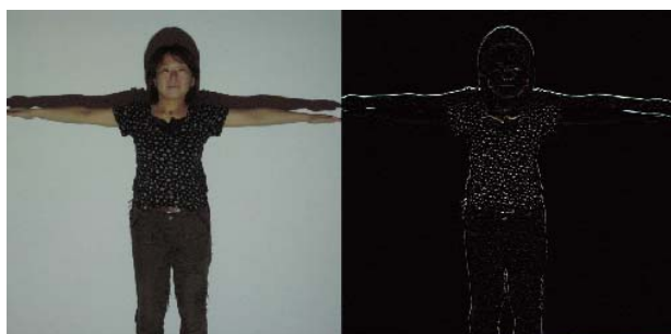
図4 水平方向フィルタによる検出
