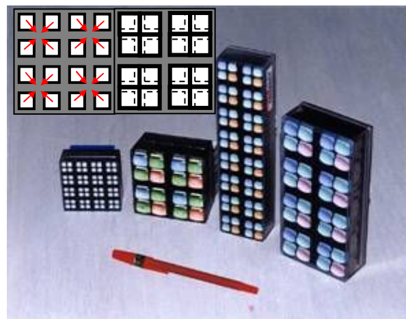
図5 高開口率画素配列の適用例
