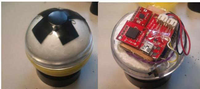
図 2 ゲームインタフェースの外観と回路基板
