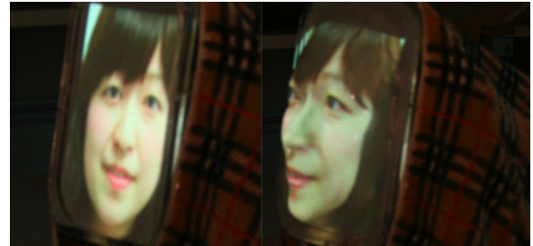
図 6 スクリーンの比較：2 種類のスクリーンに同じ画像を投影している。左図が平面スクリーン、右図が顔スクリーンである。
