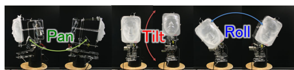
図 3 首の三軸の動作：パン-左右に首を振る動作，チルト-上下に傾く動作，ロール-左右に首を傾げる動作に対応する。
