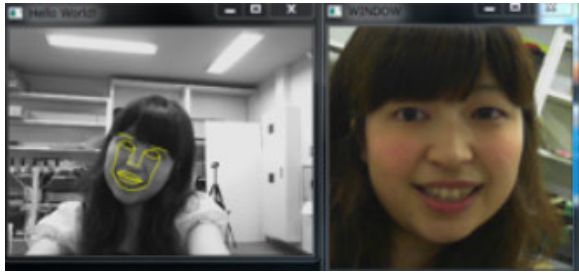
図 4 顔画像の処理：顔認識が行われている時のスクリーンショットである。左図のように首を傾げた状態から画像補正後、右図に示す顔テクスチャが生成される。画像は投影用に反転させる。
