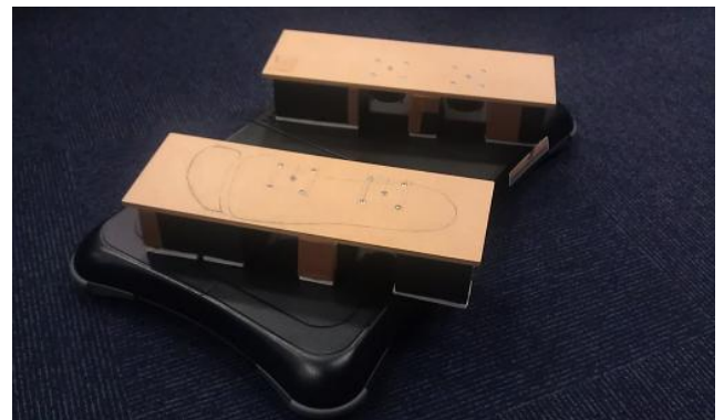
(a) 体重移動入力装置 (バランス Wii ボード) と 振動提示装置試作機
