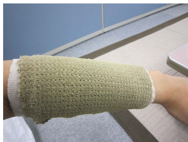
図 3 開発した三層構造導電布サポーター
