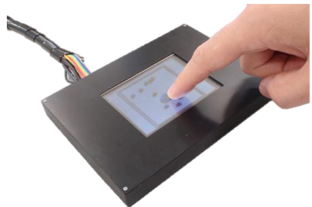
図1 モバイル用触力覚タッチパネル Fig.1 Haptic Touch Panel Display for mobile.
