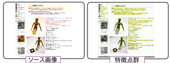
図 9 Vuforia Augmented Reality SDK にて計算される画像の特徴点群 . 左) ソースとなる画像, 右) 計算される画像の特徴点群 .
