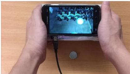
図5—磁石を固定して、デバイスを動かし、シーンのナビゲーションを行う
