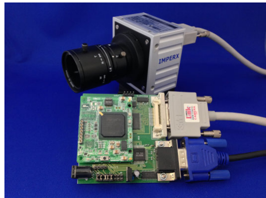
図 5 開発した高速カメラと FPGA によるカメラシステム
