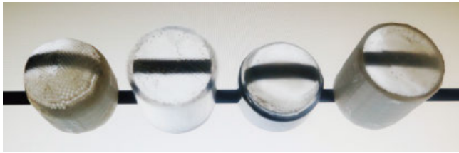
図 2 解像度の差. 左側二つの Ficon は 1mm \phi , 右側二つは 0.5mm \phi の光ファイバで構成されている.
