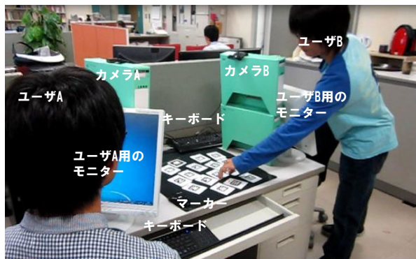
図 2 カードゲームシステムの構成
