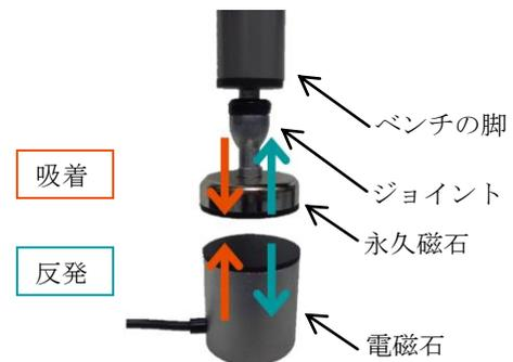
図3 ベンチ可動部の機構
