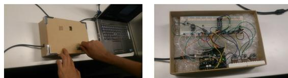
図 2 ひやひや爆弾の外観(左), Arduino を用いた中身(右)
