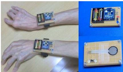
図3：ウェアラブルモジュールと装着の様子
