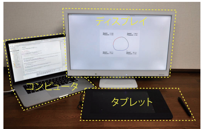
図4 試作システムの構成
