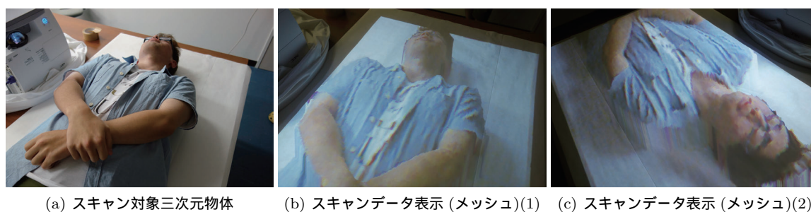
図 8 三次元物体のスキャンとコピー物体表示の実験例 (2)
